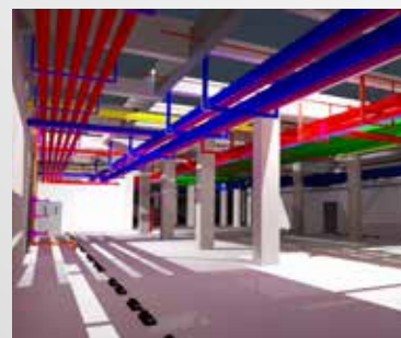
BIM 室内管廊施工放样
